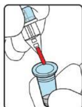
5. Proben-Nehmer mit der Kapillare nach untenweisend auf den Proben-Mischer aufstecken und durchdrücken dicht verschließen.
